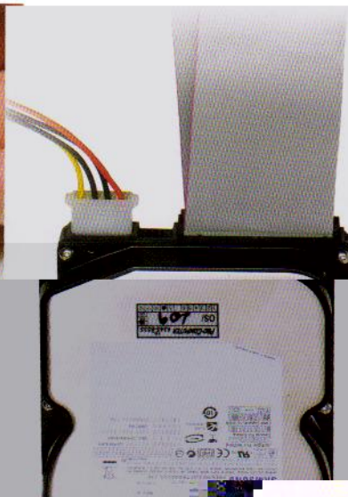
Esta é a visão em detalhe da conexão do cabo IDE no HD, realizada no passo 5.
