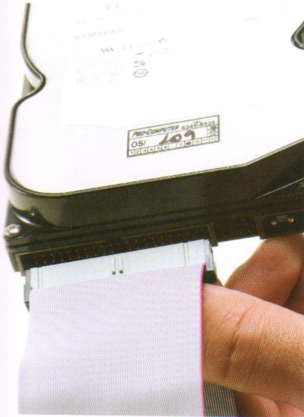
Esta é a visão em detalhe da conexão do cabo IDE no HD, realizada no passo 5.
